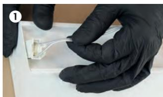
Die bestehende Leuchte öffnen. Lampensockel entfernen.
