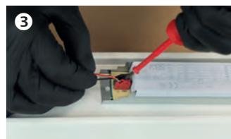
Zuleitungskabel und LED-Anschluss anschliessen und Lumenstärke einstellen.
